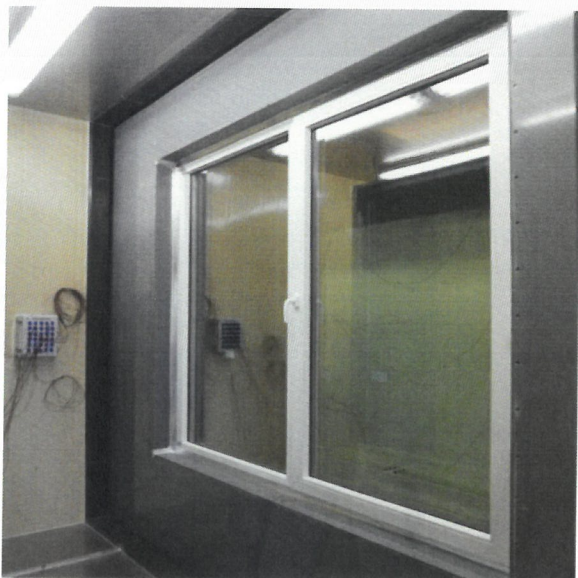
<사진 1> 열관류율 향온측 시험체 모습
