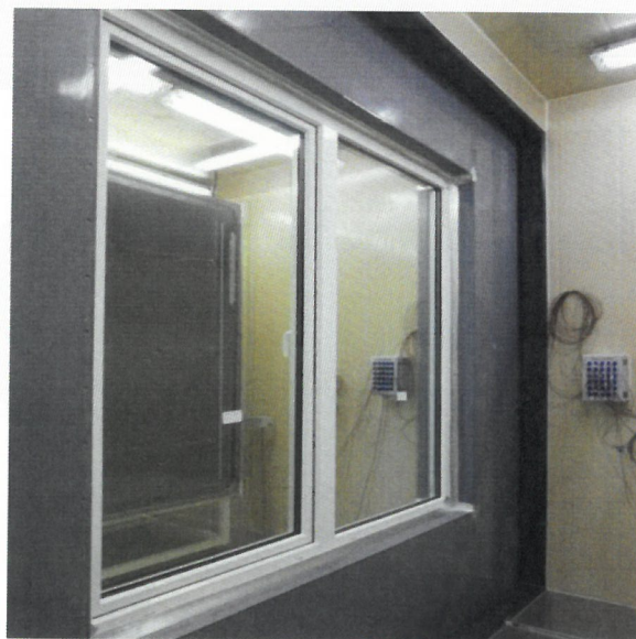
<사진 2> 열관류율 저온측 시험체 모습
